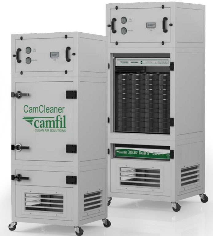
CamCleaner 1000V El CC1000V es un purificador de aire versátil que puede configurarse con filtros de partículas certificados por ASHRAE y los cilindros CamCarb CG adecuados para abordar gases como COV, peróxido de hidrógeno, ácido peracético, ozono, formaldehído, amoníaco, dióxido de nitrógeno y dióxido de azufre.
