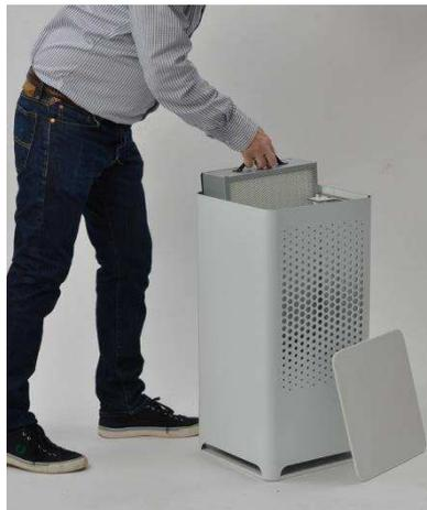
6. Coja un nuevo filtro HEPA de su caja. No toque la superficie del filtro. Sostenga solo el mango. Ponga el filtro en su posición presionando hacia abajo contra el patrón de agujeros. La junta negra debe colocarse hacia el patrón de agujeros de la unidad.
